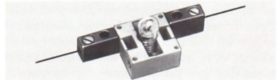
Abb. 2 Glühlampe leuchtet nicht, Kurzschluß!
