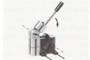
Abb.8 Taster zum Stellschalter umgebaut
